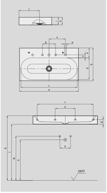
\* Foro della manopola per scarico e sistema di troppopieno CLOU con apertura dello scarico azionata a cavo e manopola montata sul bordo, con opzione a sinistra o destra
